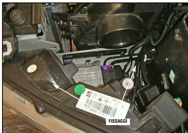
Installare la centralina Sequent Direct Injection fissando la staffa al longarone anteriore sinistro.
