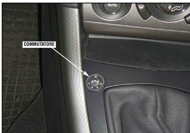
Installare il commutatore nel tunnel centrale dell'abitacolo, come mostrato in figura.
