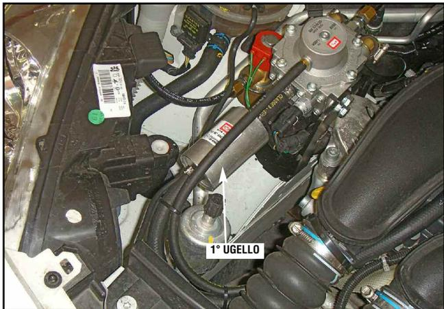
Raccordare i due tubi gas ø 10x17 mm alle estremità del filtro e fissarlo con delle fascette in nylon, come da figura.
