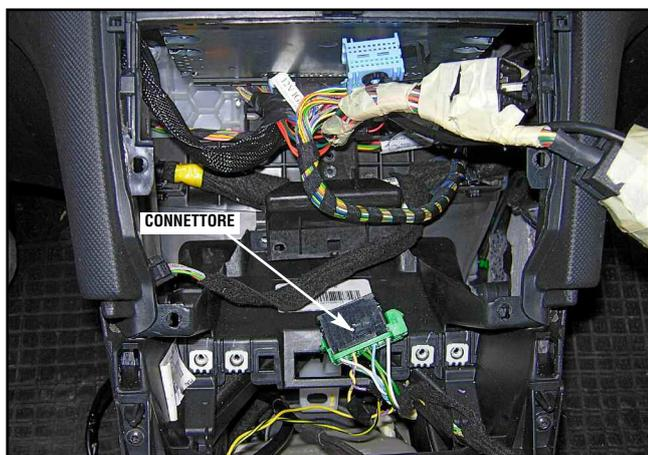
Individuare i fili per il collegamento dell'OBD all'interno dell'abitacolo, dietro la plancia centrale. Effettuare i collegamenti sul connettore indicato in figura.
