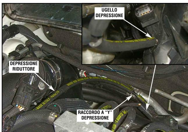
Forare ø 5 mm nel punto indicato in figura. Filettare M6, avvitare l'ugello e collegare la tubazione depressione. Effettuare uno sdoppiamento della tubazione per il successivo collegamento del sensore MAP.
