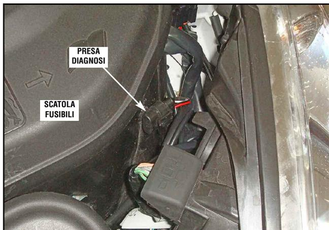
Fissare la presa diagnosi alla scatola fusibili della vettura.
