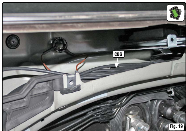
- [CBG]: cablaggio sistema gas.
