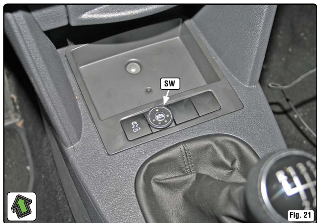
Installare il commutatore [SW] sul tunnel centrale, a fianco del pulsante del controllo di stabilità (fig. 21).
