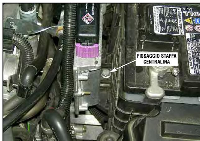
Fissare la centralina all'apposita staffa e quest'ultima nel punto indicato in figura. Connettere il cablaggio sulla centralina.
