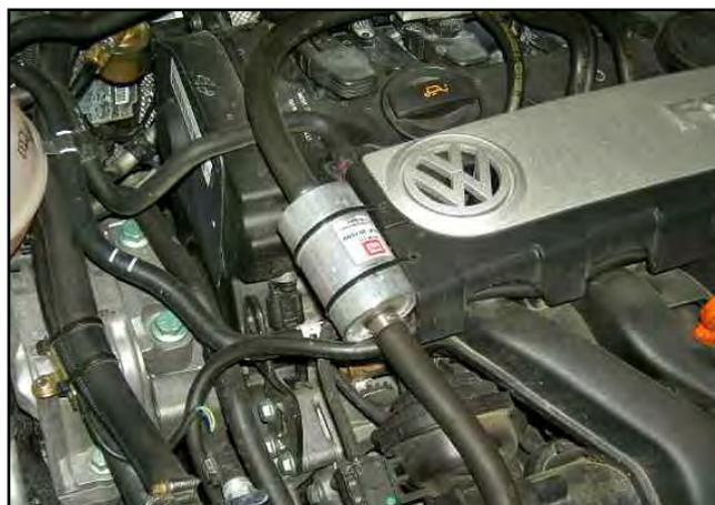
Raccordare alle due estremità del filtro i due tubi gas  $\varnothing 10-17\text{ mm}$ . Fissare il filtro ai fori presenti sul carter di protezione dei collettori con delle fascette in nylon, come da figura.
