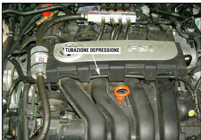
Far passare la tubazione della depressione, proveniente dal riduttore, sotto il carter di protezione collettori.
