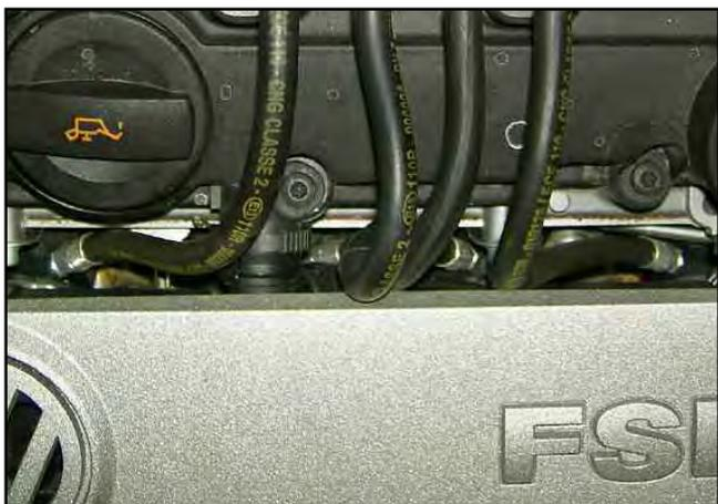
Con riferimento alle figure forare i collettori  $\varnothing 5$  mm e filettare M6.
