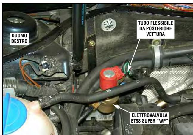
Fissare l'elettrovalvola e la staffa alla paratia, come da figura. Raccordare il tubo flessibile proveniente dal posteriore vettura. Raccordare il tubo flessibile  $\varnothing 4,8-8\text{mm}$  sull'uscita dell'elettrovalvola.
