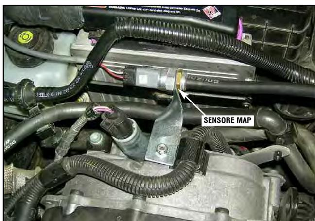
Fissare il sensore MAP alla staffa e quest'ultima nel punto indicato in figura. Ruotare la staffa in modo da portare il sensore in posizione orizzontale.
