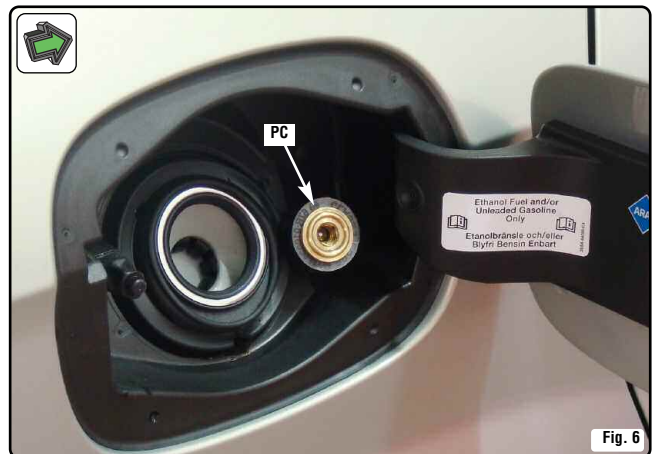
Inserire la presa di carica [PC] nel foro appena effettuato e serrarla dall'interno del passaruota, utilizzando l'apposita rondella ed il dado (figg. 6 e 7).
