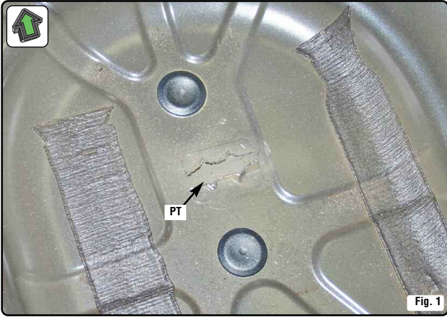
Nel vano portaruota di scorta, eliminare il perno di fissaggio della ruota [PT] (fig. 1).
