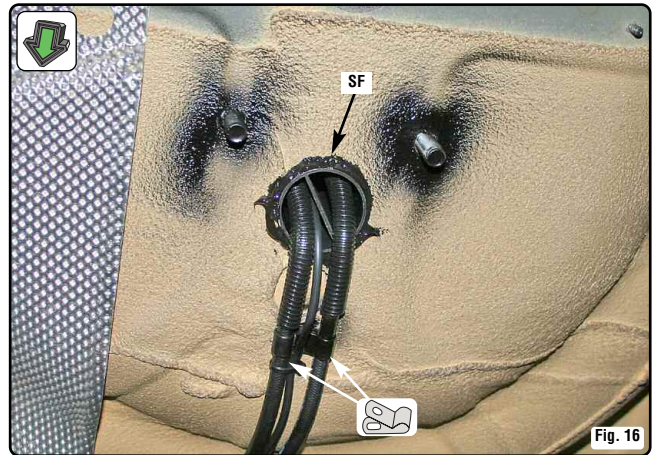
Inserire le due tubazioni flessibili nello sfiato [SF] e raccordarle sulla multivalvola (fig. 16).
