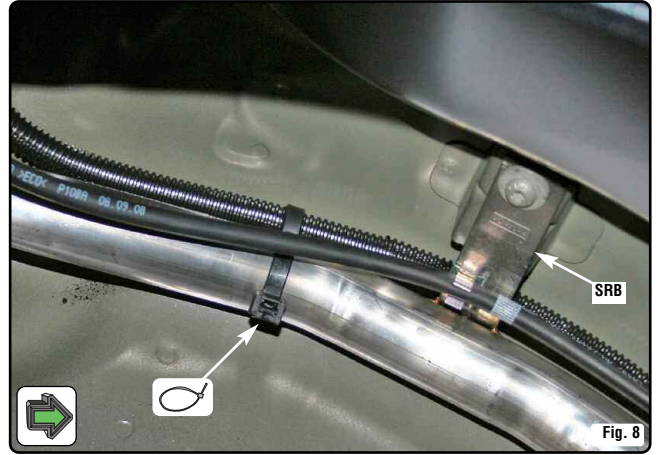
Fissare la tubazione della presa di carica lungo quella di rifornimento benzina, utilizzando 6 fascette in plastica (figg. dalla 8 alla 11). Far passare la tubazione flessibile tra la staffa di fissaggio [SRB] della tubazione rifornimento benzina e la vettura (fig. 8).
