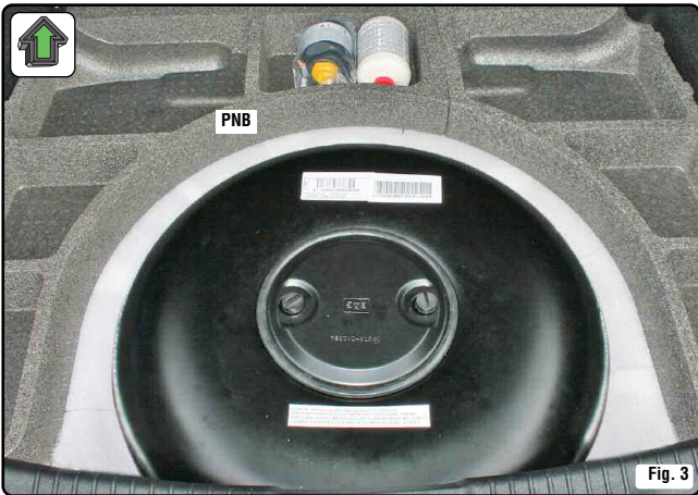
Inserire il serbatoio nella vasca portaruota con la multivalvola rivolta verso l'anteriore (figg. 3/4). Sistemare il pianale [PNB/PNS] sul fondo del bagagliaio, pizzicando il foglio antiscintillio.
